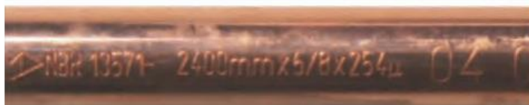
Figura 6 - Haste de aterramento de alta camada.
